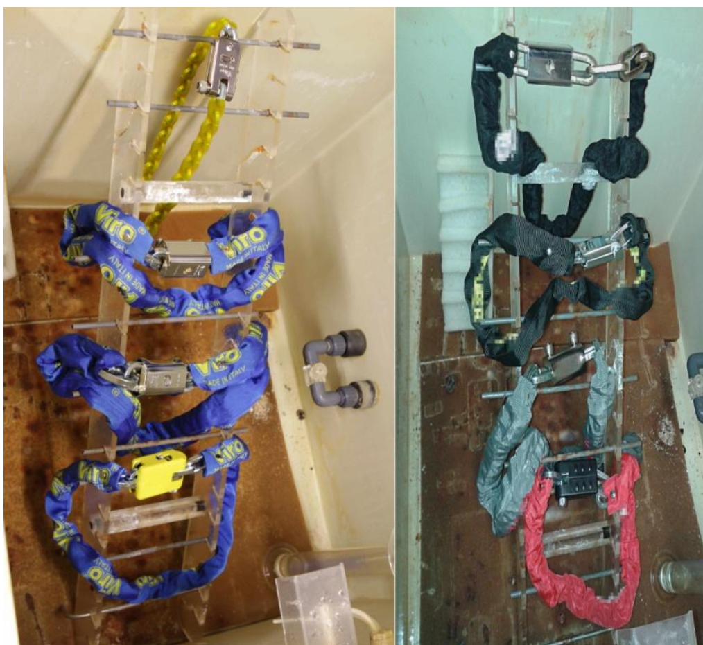
A sinistra i prodotti originali Viro nella macchina della nebbia salina prima del test e a destra le imitazioni
