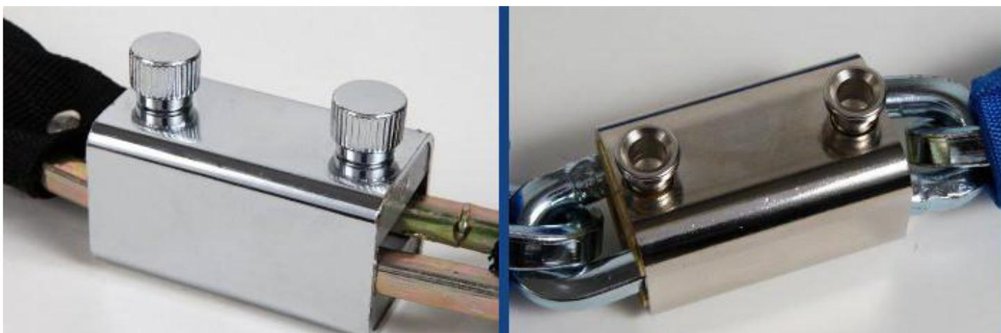
Il lucchetto Viro (a destra) ha le teste delle aste con un punto di rottura programmata, come si può notare dalla cavità al loro interno. In questo modo se, con strumenti da scasso, si cerca di strappare l'asta tirandola per la testa, questa si stacca, lasciando l'asta al proprio posto e il lucchetto chiuso. Il lucchetto imitazione, visibile nella foto di sinistra, ha invece delle aste con testa unita all'asta in un solo pezzo, facilmente afferrabile ed utilizzabile per strappare l'asta stessa
