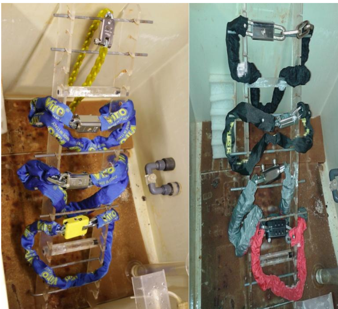
(Links de originele Viro sloten in de zoutnevelmachine, rechts de imitaties)
